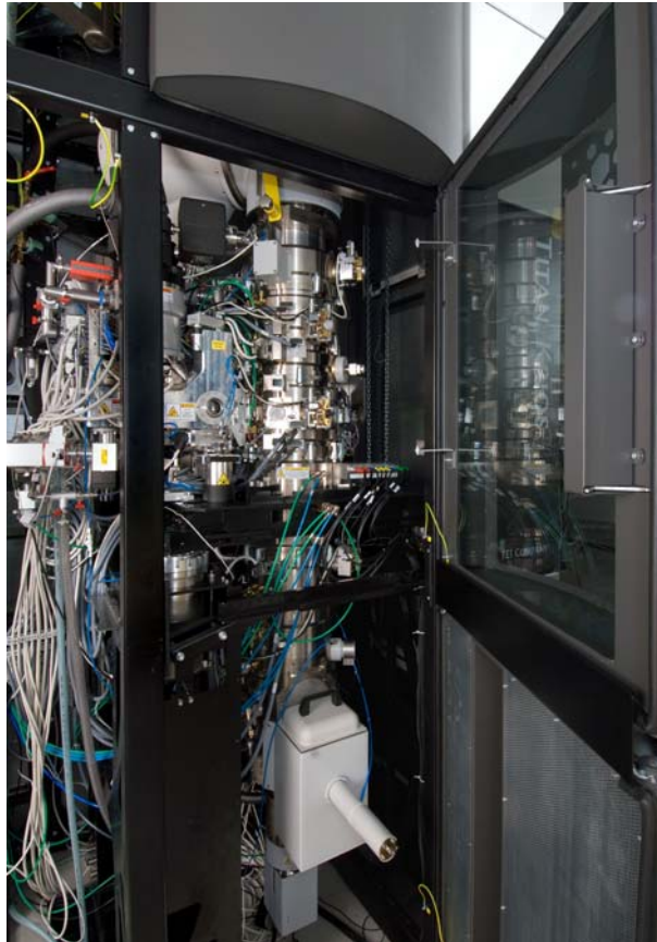
Das Elektronenmikroskop Titan Krios der Firma FEI in der „offenen Variante“. Für den „ungestörten“ Betrieb befindet sich das Mikroskop in einer 3,8 Meter hohen Box, die es von äußeren akustischen und elektromagnetischen Störquellen abschirmt. (Bild: Stark / MPIbpc)
